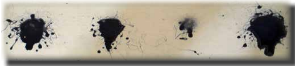
Sprühbild mit herkömmlichem Schmierstoff. Diese teerhaltigen Schmierstoffe sind oft die Ursache, dass Sprühdüsen verstopfen, was zu Problemen bei der Anwendung des Schmierstoffes und zu Beschädigung durch kritische Lastpunkte in den Getrieben führt.
