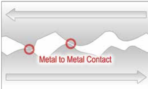
Abb. 1: Unebenheiten auf sich berührenden Metalloberflächen
