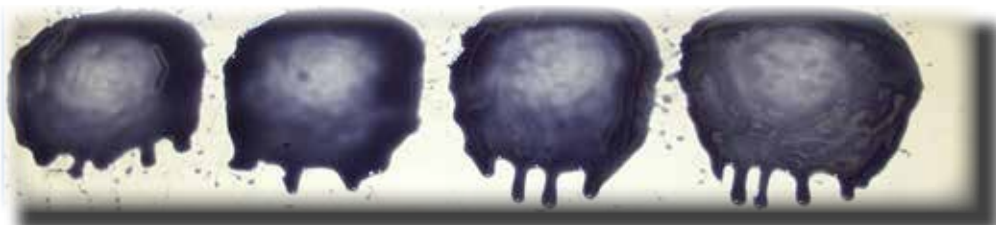
Sprühbild nach der Umstellung auf Pyroshield Syn Schmierstoff. Die Sprühdüsen werden durch Pyroshield Schmierstoffe nicht verstopft, dadurch stellen sie einen gleichmäßigen Schmierfilm zum Schutz für die Getriebe bereit.
